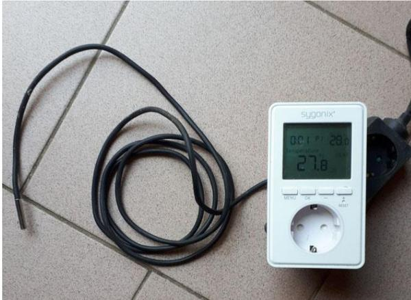
Wärmequellen sollten exakt auf die korrekte Temperatur eingestellt sein. Große Vorteile zum Einhalten der gewünschten Stalltemperaturen bringen Thermostate, um die Wärmequellen zu regulieren.
